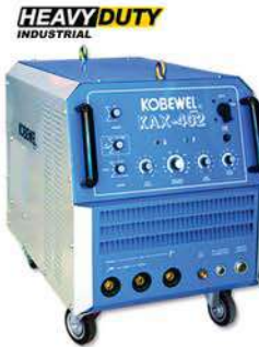
KAX 402 420 A , 60 % , 3 Phase Rectifier Technology
